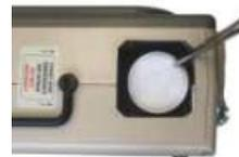
Entfernen Sie den Scheibenfilter mit der Gefäßklemme oder einer Pinzette, und ersetzen Sie ihn durch einen neuen, sauberen Filter. Stellen Sie sicher, dass der Filter flach auf dem Rand in der entsprechenden Aussparung aufliegt.
