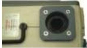
1. Entfernen Sie die vier (4) 8-32 x 3 Kreuzschlitz-Flachkopfschrauben, mit denen der Einlassanschluss des Kompressors an der Abdeckung befestigt ist.
